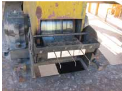
Bei VAM ist heute ist die gesamte Rollenbreite von 240 mm mit Blöcken bestückt und damit komplett wartungsfrei.
