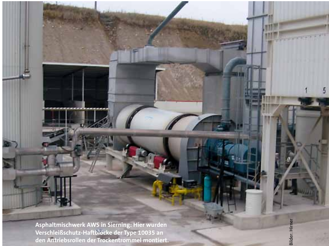
Bei VAM ist heute ist die gesamte Rollenbreite von 240 mm mit Blöcken bestückt und damit komplett wartungsfrei.
