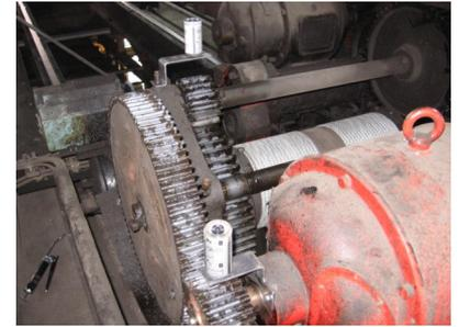
Aufbringung des innovativen Trockenschmiermittels über Kartuschen
