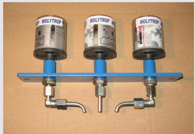
Montage der Automatikkartuschen mit Schmiermittelzuführung
