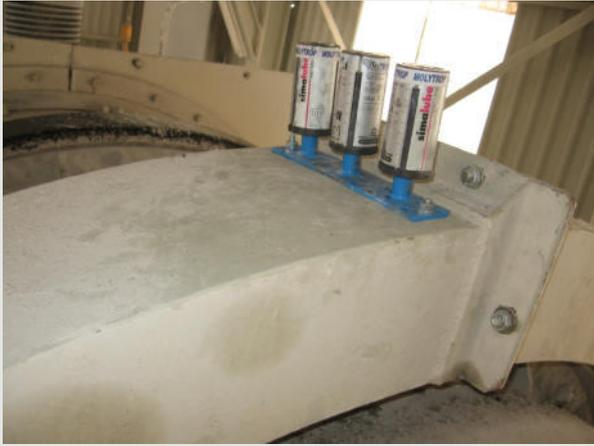
Kartuschen an Zahnkranztrieb
