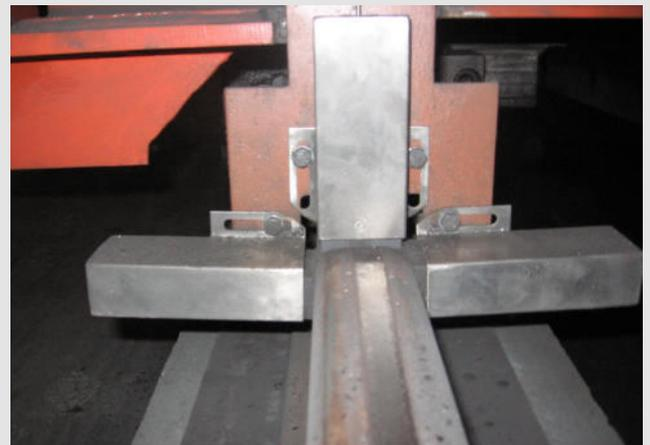
Haft und Schmierblöcke an Bodenschiene
