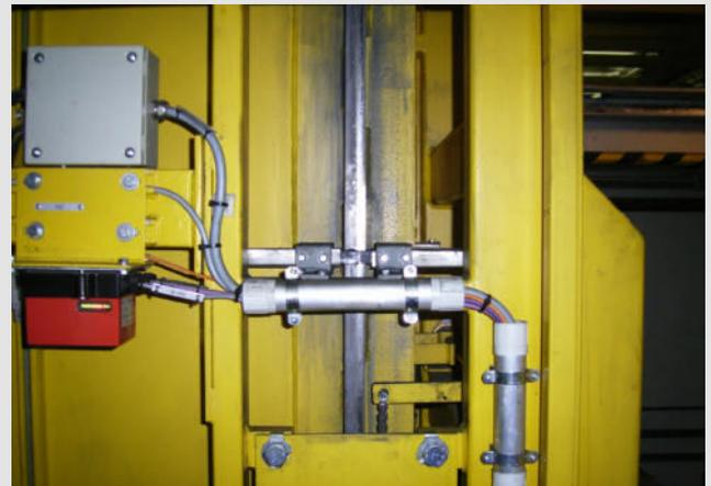
Schmierblöcke an Vertikalschiene
