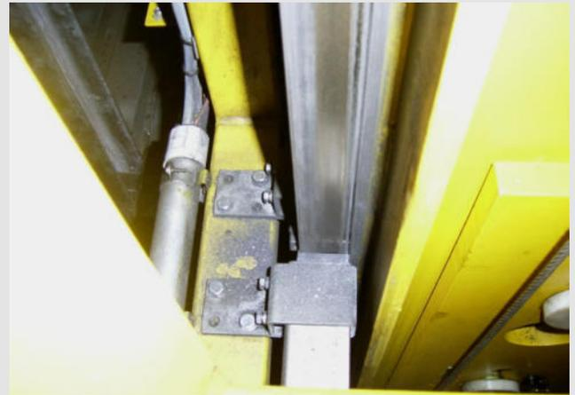
Schmierblock an Vertikalschiene
