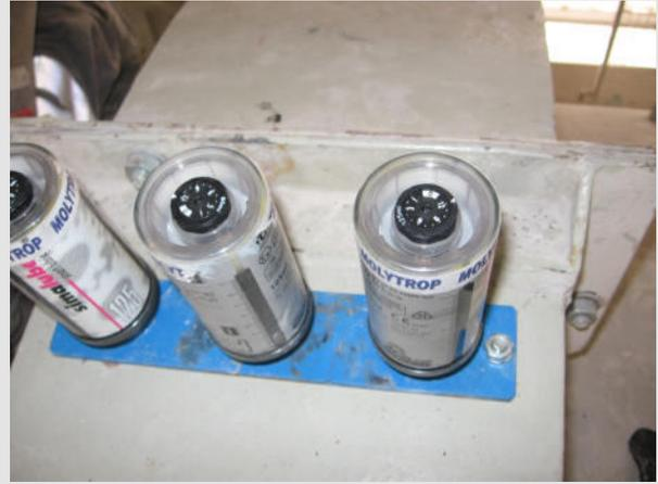
Kartuschen an Zahnkranztrieb
